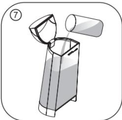
Снова залейте в бачок 0,65 л жидкости для удаления накипи до отметки MAX и повторите шаг 6, пока бачок не опорожнится.
