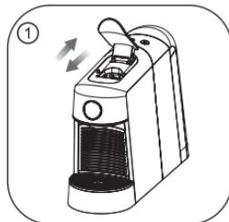
Поднимите и закройте верхнюю крышку, чтобы капсула упала в коробку для отработанных капсул.
