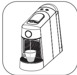
Індикаторна лампочка кнопки великої і малої чашки мигає одночасно з частотою 1 раз на секунду (лампа підсвічування горить постійно). Час попереднього розігріву становить приблизно 35 с. Після попереднього розігріву відбувається перехід у режим очікування. При першому використанні або після тривалого простоя заваріть чашку гарячої води, щоб почистити апарат.
