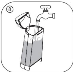
Спорожніть і сполосніть водяний бачок. Заповніть його прісною питною водою.
