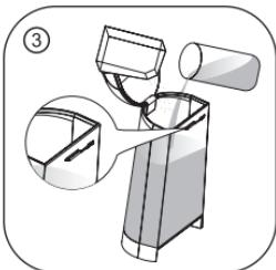
Смешайте жидкость для удаления накипи с водой в соотношении, указанном в инструкции. Заполните водяной бачок питьевой водой на 0,65 л.
